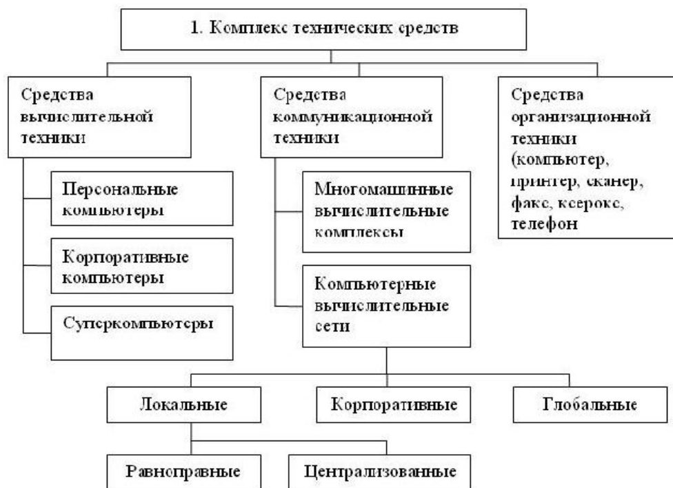
Рисунок 1 - Структура комплекса технических средств АИТ
